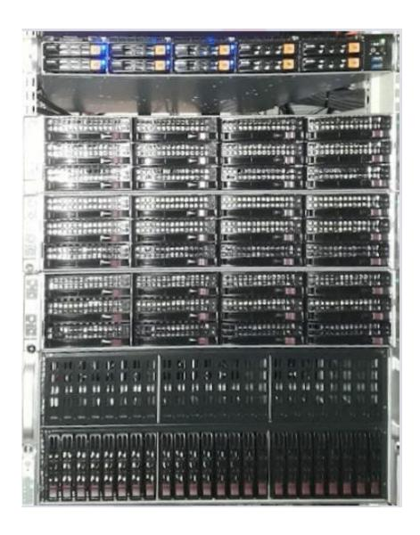
Todos los nodos y equipos están montados en rack en un armario de 19" con un sistema de ventilación y extracción adecuado y un sistema de alimentación ininterrumpida.
